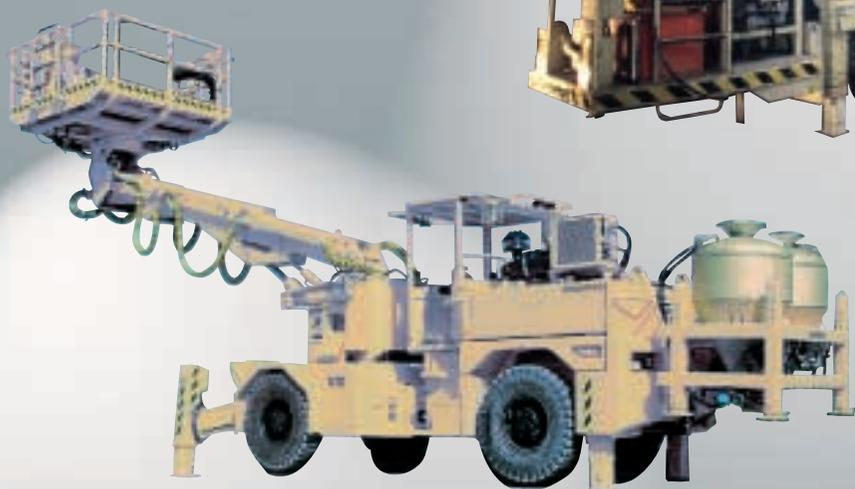
**Charmec 1610 B** предназначен для высокопроизводительной механизированной зарядки ВВ в горных выработках. Машина оборудована навесным зарядным оборудованием, включая 2 x 500 кг емкости АНФО, зарядные шланги для одновременной работы 2 или 4 взрывников, устройства управления, изолированное хранилище для детонаторов и компрессор зарядного воздуха. Подъемная стрела и люлька предназначены для зарядных работ на высоте до 8,4 м.
