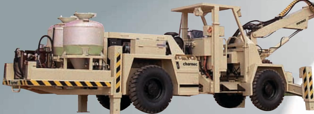
**Charmec 9905 BC ANT** оборудован двумя подъемными стрелами, 2 x 500 кг. емкостями АНФО и воздушным компрессором. Машина предназначена для работы в туннелях большого сечения. Рабочая зона с одной установки составляет до 11,7 метров в высоту и до 16 метров в ширину, что позволяет работать в туннелях практически любого профиля. Кроме того машина является весьма универсальным инструментом для многих средних высотно-монтажных работ.
