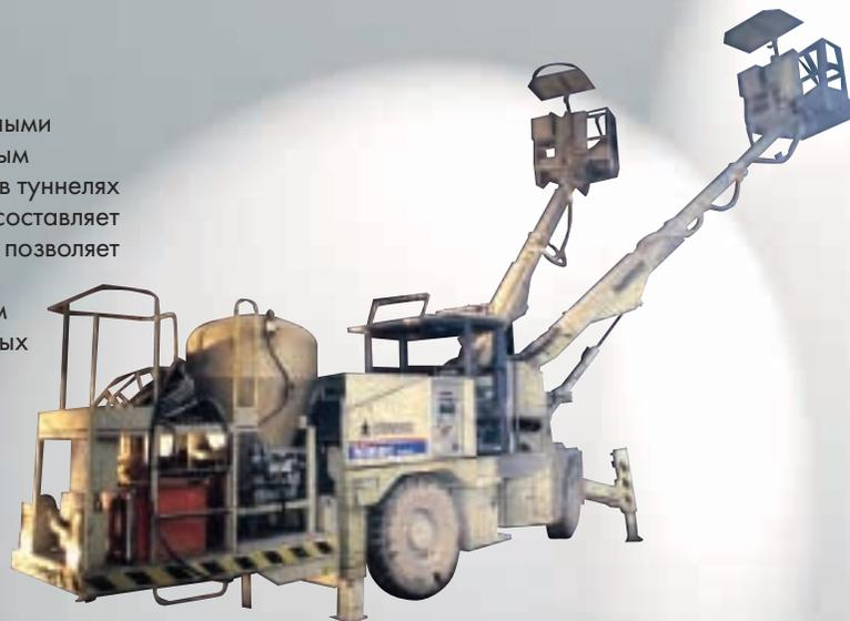
**Charmec 9910 BC ANX** с двумя емкостями АНФО по 500 кг оборудован усиленной стрелой Normet Superboom и подъемной платформой, способной легко поднимать бригаду зарядчиков с инструментом на высоту до 10 м, обеспечивая комфортные условия работы в рабочей зоне шириной до 12,5 метров. Встроенный компрессор обеспечивает подачу необходимого для зарядки воздуха, для хранения взрывателей и детонаторов предусмотрен отдельный изолированный ящик.
